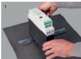
1 支撑轨道上的变频起动器弹开。
