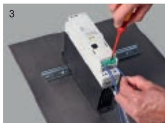
3 连接控制电流的线路。
