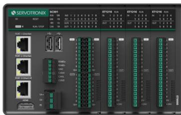
图 2-2 SC301 运动控制器 + ET 系列 IO 模块 正面图
